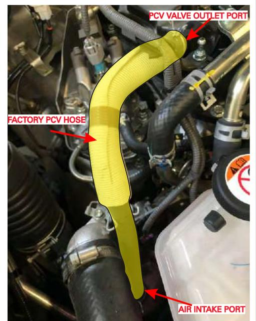
FIG. 4 FACTORY PCV HOSE IDENTIFICATION
